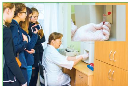
А дальше кровь отправляется в гематологический анализатор – прибор для подсчета ваших тромбоцитов и гемоглобина. Фельдшер-лаборант подносит пробирку с кровью к игле, которая всасывает кровь внутрь. Затем идет смешивание крови с разными реагентами, после чего аппарат выдает бланк с результатами. Эта процедура занимает ровно две минуты на каждого человека.
