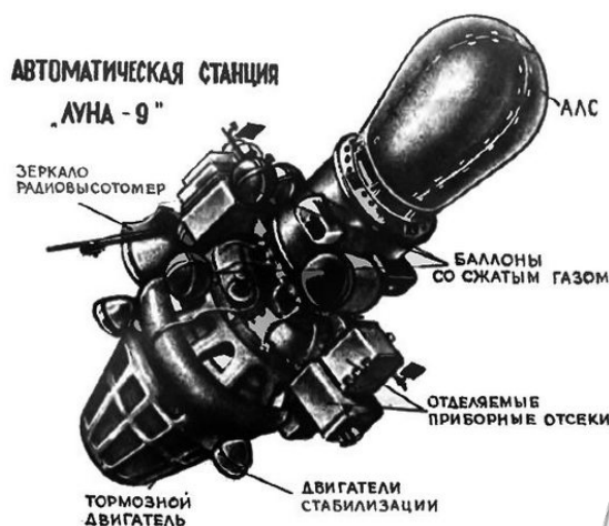
Составные части станции «Луна-9»
